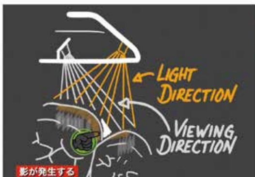
写真11 三角計測法の弱点は撮影時に影が発生する(国際コンピュータ歯科学会資料より引用改編)
